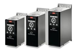
Компания FORMATECH по желанию заказчика производит установку преобразователей частоты. Преобразователь частоты (ПЧ) представляет собой электронный блок управления, который изменяет частоту тока, регулируя скорость вращения ротора электродвигателя, в соответствии с текущим режимом по-требления сжатого воздуха. Применение ПЧ позволяет получить значительную экономию энергии.
